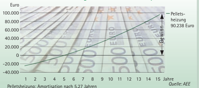
Abb. 3: Die Kosten für die neue Pelletsheizung amortisieren sich nach gut fünf Jahren, nach 15 Jahren beträgt die Ersparnis 90.238 Euro.
